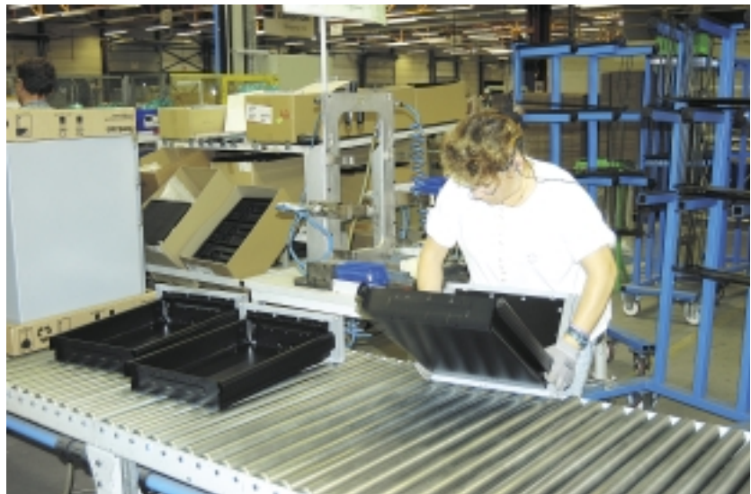
Assemblage des tiroirs puis incorporation dans les caissons avant finition
