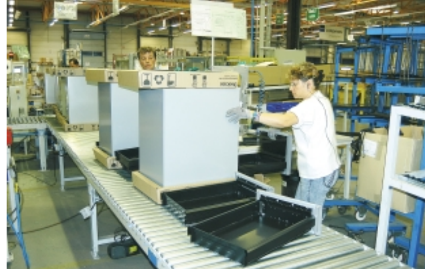
Assemblage des tiroirs puis incorporation dans les caissons avant finition
